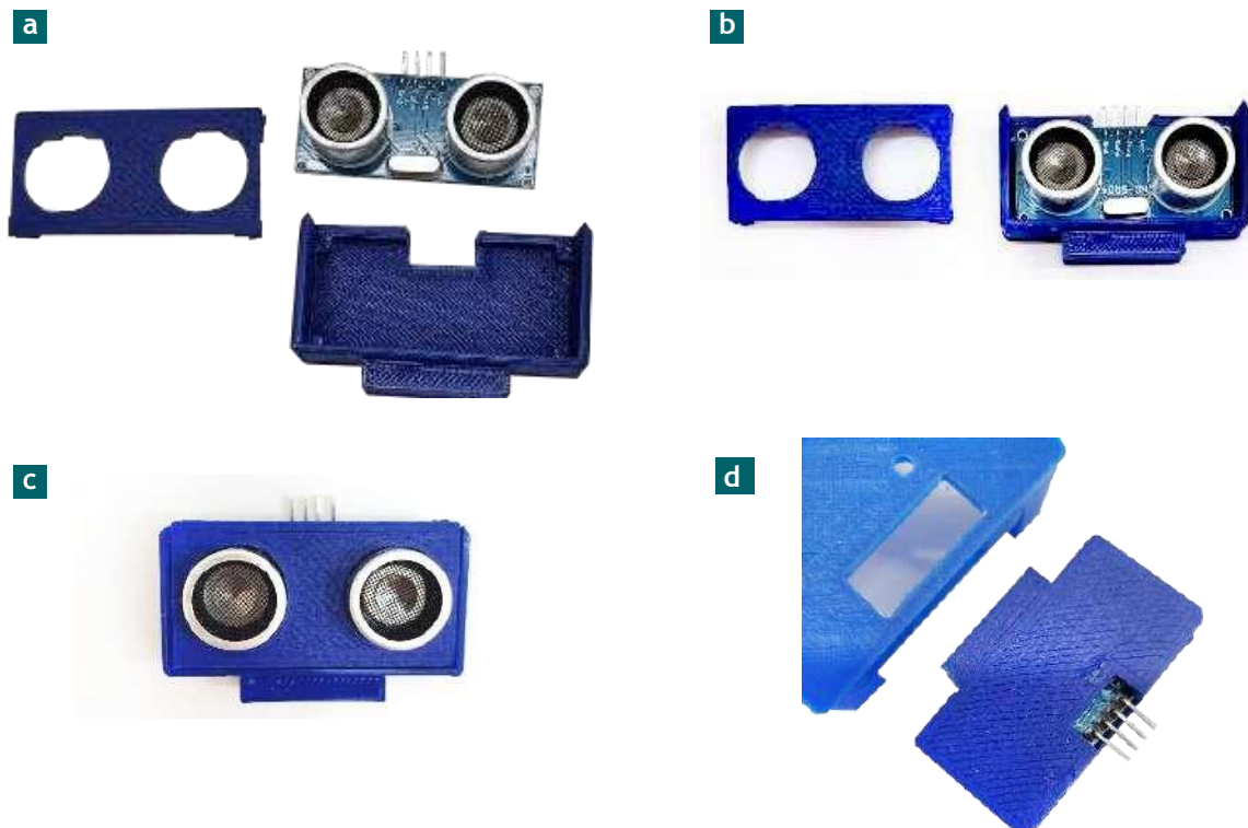
Figura 6. Paso 3: Montaje del sensor de distancia en el cuerpo principal del chasis.
