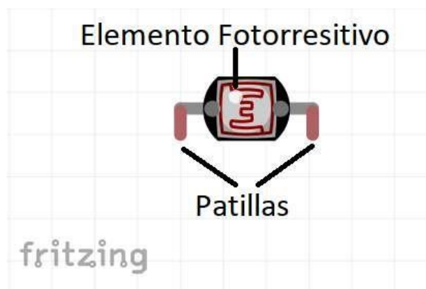
Figura 2. Componentes principales del módulo sensor fotorresistor LDR.
