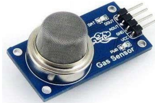
Figura 2. Pines para conexión eléctrica del sensor MQ-135. Dependiendo del fabricante, puede variar el orden de los pines en el módulo sensor.
