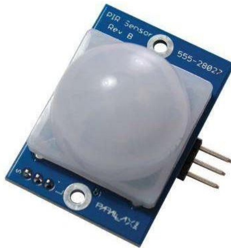
Figura 13.1: Sensor de presencia o movimiento PIR.
