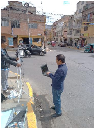
Figura 8. Sensor de CO2 de uso comercial utilizado para calibrar el sensor construido en este proyecto.
